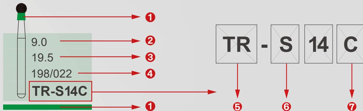
① 颜色标识: 不同颜色代表金刚砂粒子不同的粗细程度
